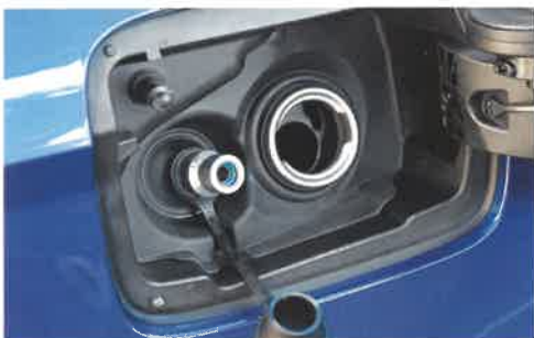
Plnenie a tankovanie pod jedným vekom, vľavo plyn, vpravo benzín
