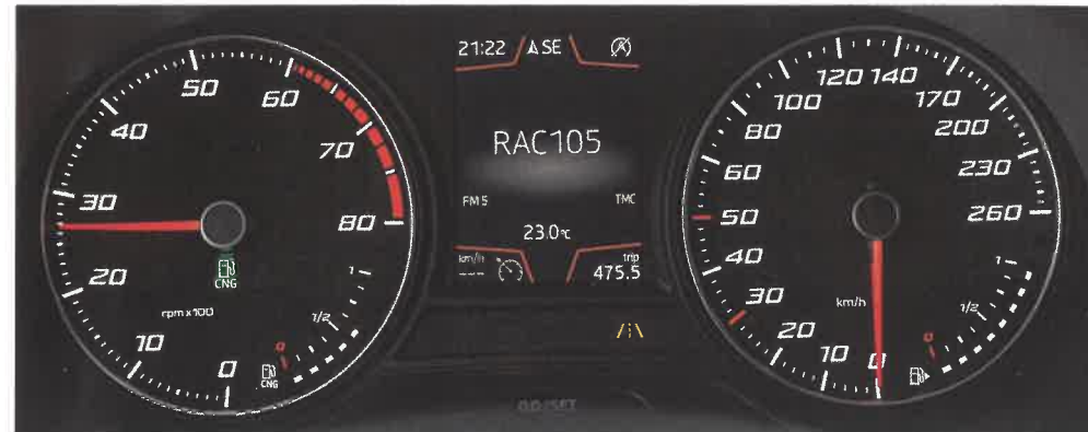
Zelená kontrolka signalizuje, že motor spaľuje plyn, vľavo je tiež ukazovateľ stavu plynu, vpravo benzínu
